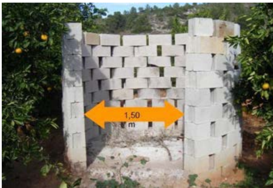
Foto 1. Abertura lateral o boca de alimentación de un quemador agrícola.
